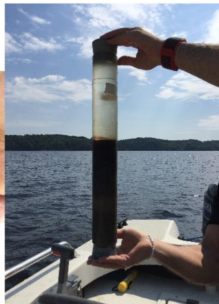
Figur 2. Sedimentinnsamling i juni 2016 på 80m dyp fra båt. Sedimenter ble skivet på stedet med 1 cm intervaller.
