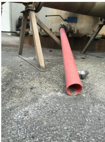
Figur 1. Tappepunkt for uttak av prøve i bunn av vasketårn på anodefabrikken. Foto: Vogelsang.
