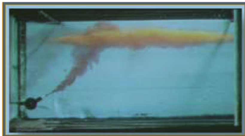
Figur 24. Foto frå laboratorieforsøk med farga oppstigande (lett, ferskt) vatn i ei sjikta væske (sjøvatn).
