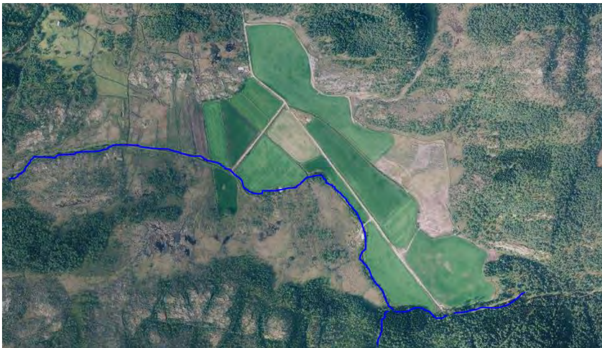
Figur 24. Drenering og oppdyrking av Tøløkmyrene i øvre del av nedbørsfeltet har ført til en markant økt tilførsel og transport av sand til Segeråga. Flyfoto fra 2013 ( http://kart.finn.no/ ).
