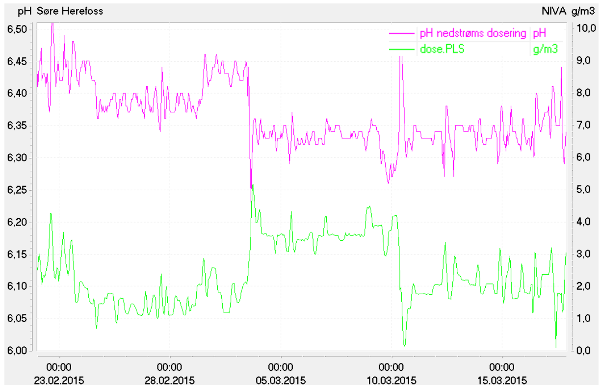
Figur 8. Kalkdosene levert fra doseringsanlegget og pH nedstrøms anlegget. Det var ingen reaksjon i pH på dobling av kalkdosene.
