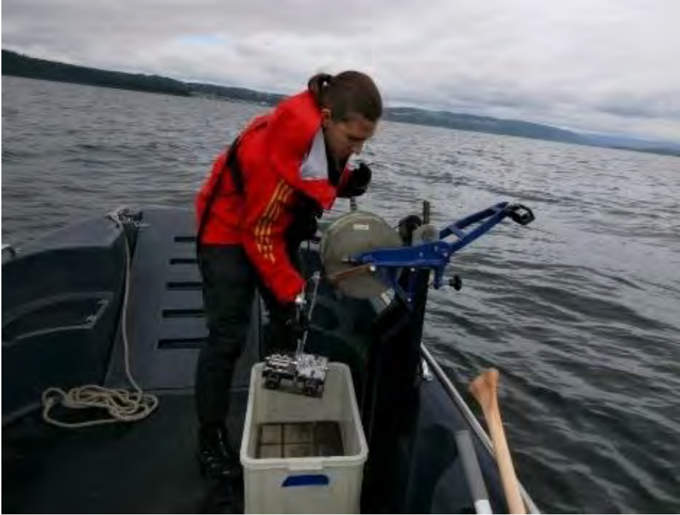
Figur 5. Sedimentprøver for analyser av radionuklider tas fra bunnen utenfor stasjon B2.
