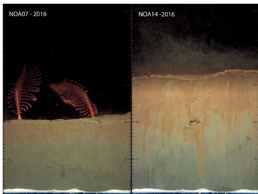
Figur 11. Bildeeksempler fra SPI-kameraet. På mange stasjoner, f.eks. på NOA07 ble det observert en del ulike sjøfjær. Man kan tydelig se tegn til fauna og fargeskillet som indikerer skillet mellom oksidert og redusert sediment.
