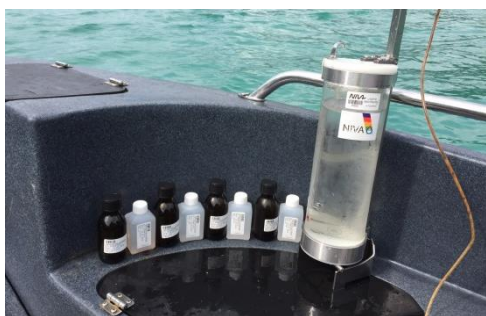
Figur 4. Limnos vannhenter benyttet for vannprøvetaking (Foto: NIVA)
