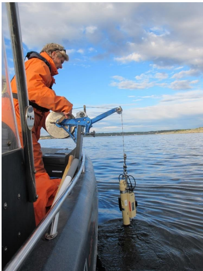
Figur 5. Måling av temperatur, saltholdighet og oksygen på stasjon Sand 3 med en profilerende CTD-sonde
