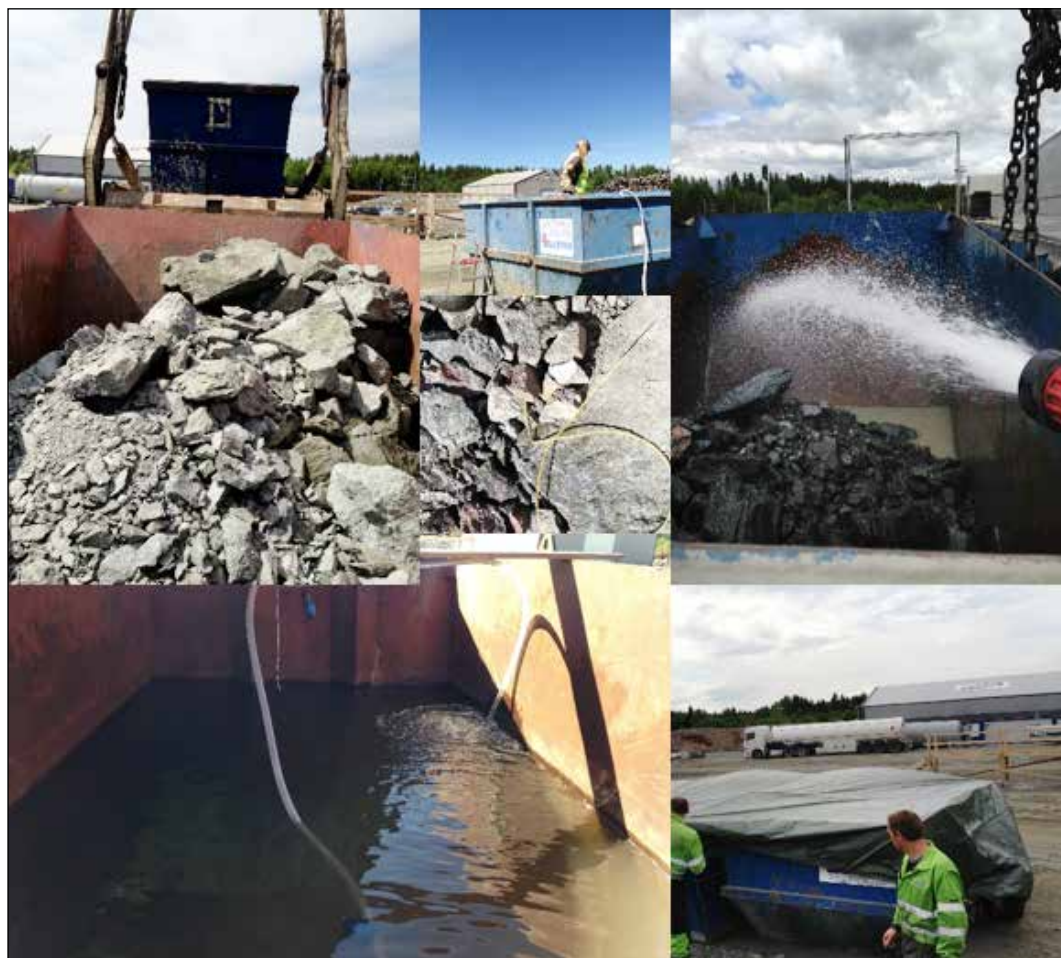
Figur 4. Bestemmelse av uomsatt sprengstoff i sprengstein fra Espatunnelen ved Sørli tømmerterminal.
