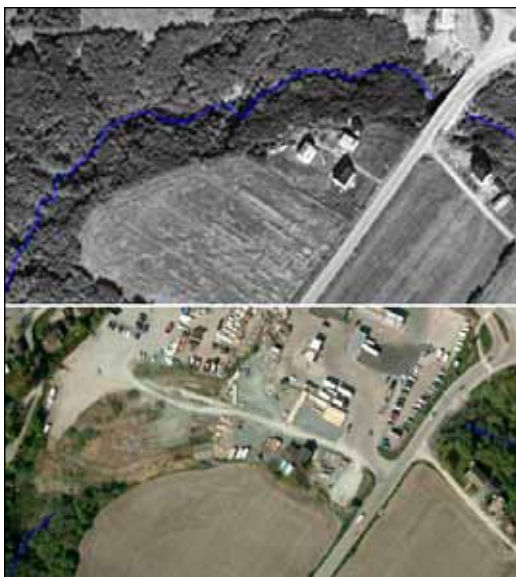
Figur 12. Dagens problemområde på Klett i Sørå ble lett forsert av sjøørret på vei opp til ovenforliggende gyteområder i Sørå i 1964 (øverst), men lukking og rørlegging av bekken etter dette ødela vandringsmulighetene (nederst). Nå skal ny E6 anlegges i dette området, og en må sikre at kontinuiteten for fiskevandring gjenopprettes. (Flyfoto hentet fra http://kart.finn.no/ ).
