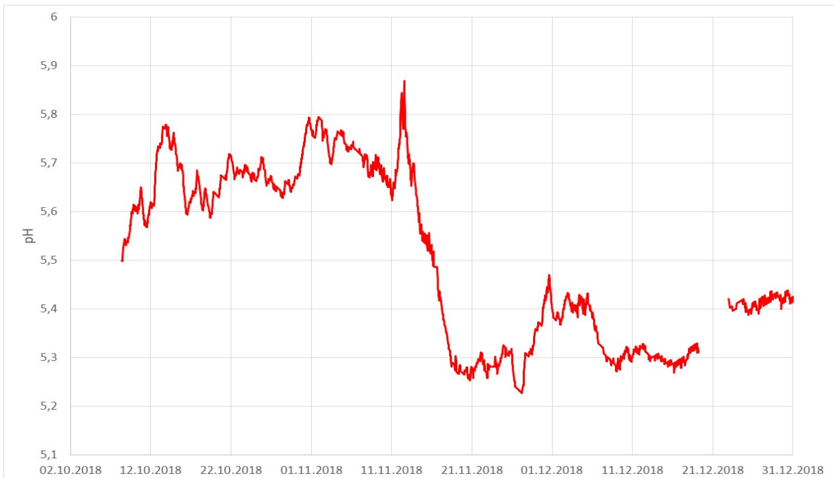
Figur 4 pH oppstrøms Bås doseringsanlegg høsten 2018. Det er ikke organisert kalking oppstrøms pH-måleren.
