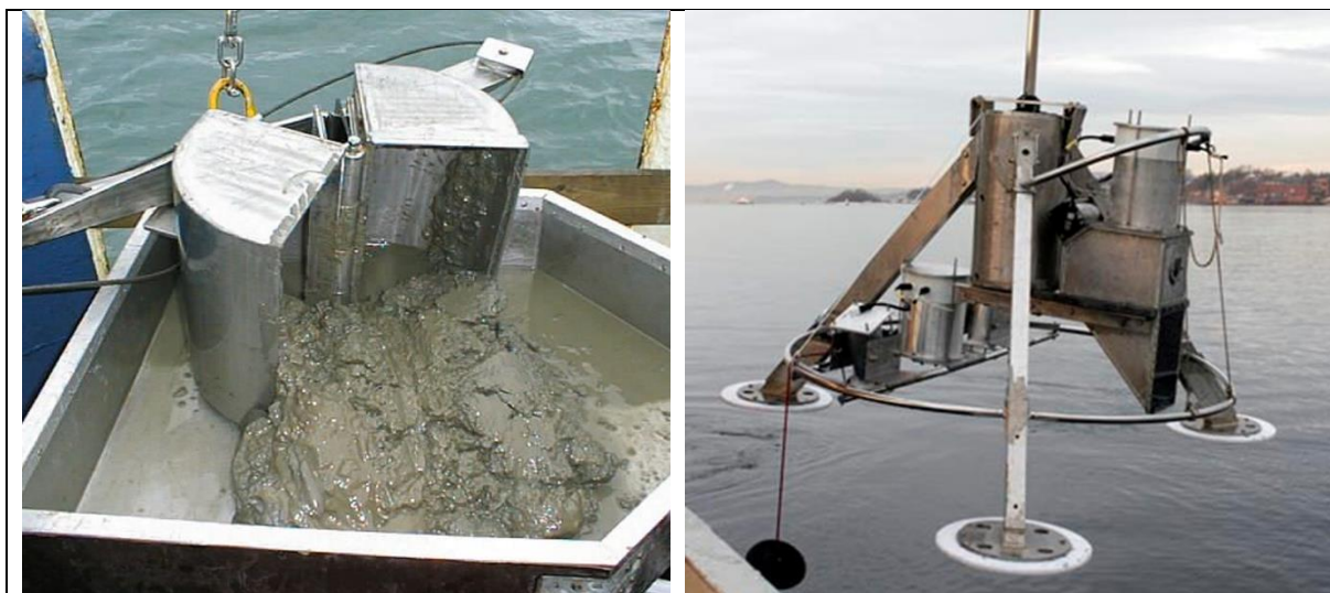
Figur 14. Van Veen-grabb (venstre) som benyttes til prøvetaking av bløtbunnsfauna og SPI-kamera (høyre) som tar et horisontalt bilde av sedimentet. Foto: NIVA
