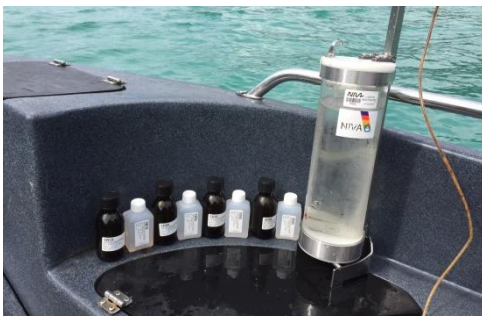
Figur 4. Limnos vannhenter benyttet for vannprøvetaking (Foto: NIVA)
