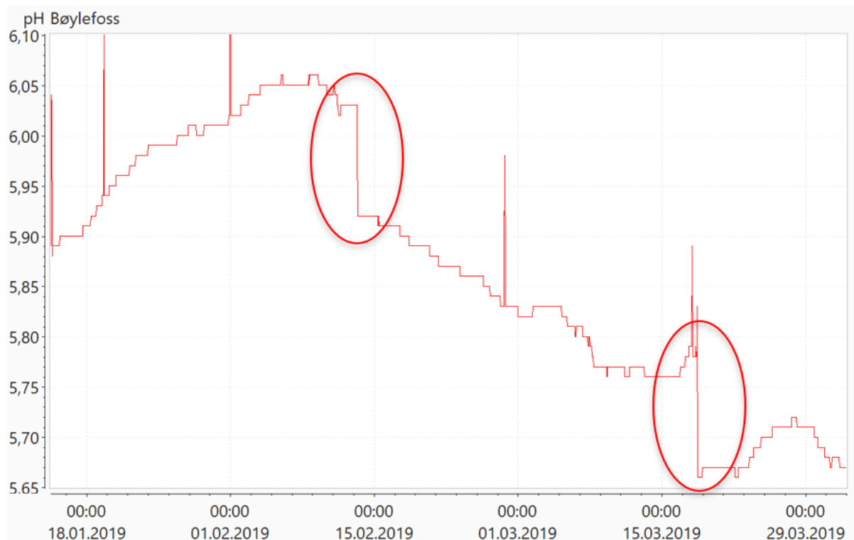
Figur 3. Eksempel på pH-kurve som korrigeres ved prosessskalibrering to ganger i løpet av en måned.
