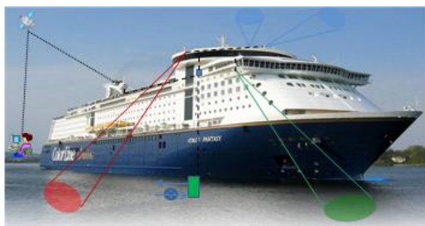
Figur 22. MS Color Fantasy illustrert med dekkens sensorer for lys (blå), havfarge (grønn), overflatetemperatur (rød), kommunikasjon til land og FerryBox systemet omtrentlig plassering i fartøyet.
