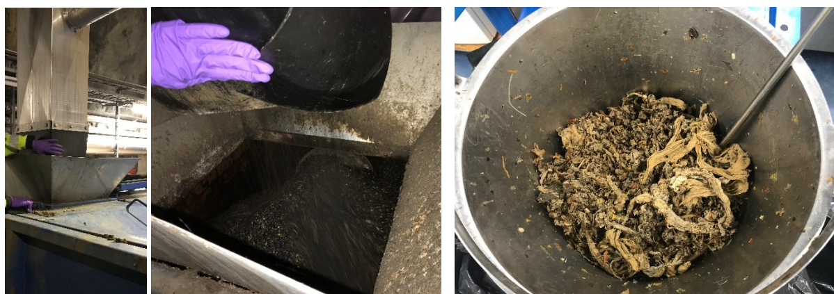
Figur 12. Venstre side: Under kraftig nedbør ble stikkprøvene av sand og ristgods tatt direkte fra nedfallet til den respektive kontaineren. Høyre side: Stikkprøvene ble blandet sammen i en rustfri stålbøtte ved hjelp av en rørestav i rustfritt stål ved å røre godt om i ca. 1 min.
