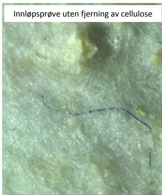
Figur 18. Cellulosefibre som dekker filterpapiet etter behandling av en innløpsprøve med 30% H_2O_2 . Et enkelt blått mikroplastfiber kan skimtes gjennom og mellom cellulosefibrene.
