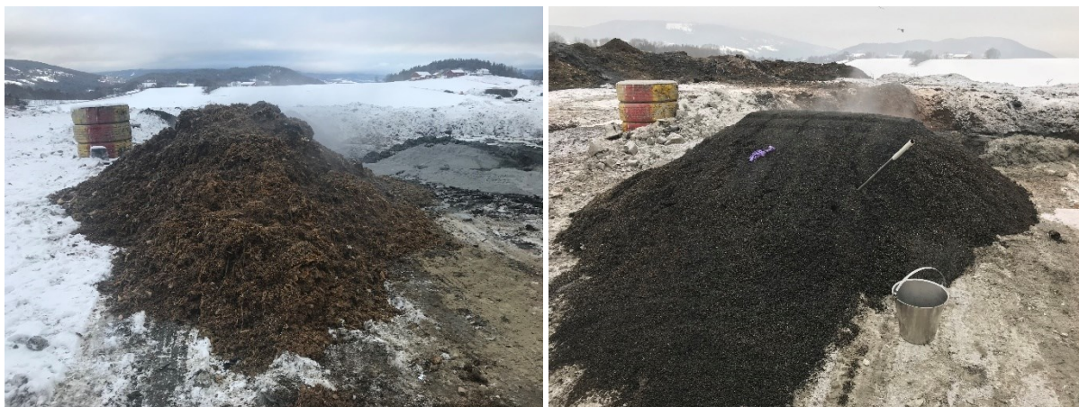
Figur 11. Venstre side: Det ble tatt ut stikkprøver av ristgods fra ca. 20 ulike punkter rundt haugen med ristgods umiddelbart etter dumping av ristgodskontaineren. Her på Lindum. Høyre side: Også av sand ble det tatt stikkprøver fra ca. 20 ulike punkter rundt haugen med sand umiddelbart etter dumping av kontaineren med sand. Her ble det benyttet et metallrør. Stikkprøvene ble overført til en godt vasket og skylt bøtte i rustfritt stål og dekket til med aluminiumsfolie.
