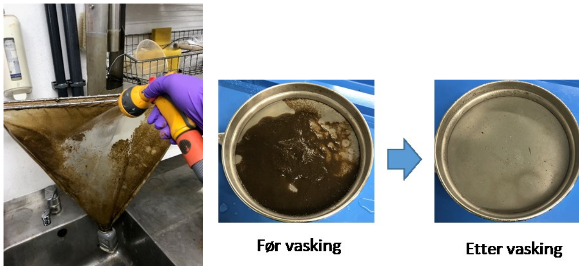
Figur 10. Oppsamling og vasking av materiale akkumulert i den spesialdesignet prøvetaker for å ta ut flytende partikler i utløpskanalen.
