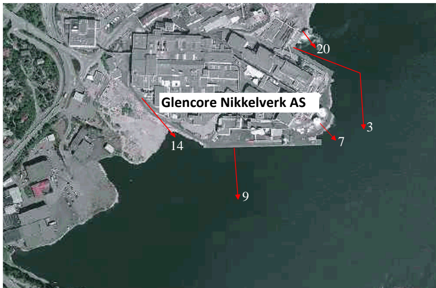
Figur 3. De fem utslippspunktene for prosessvann fra Glencore Nikkelverk AS er markert som punktene 3, 7, 9, 14 og 20 (fra Næs og Håvardstun 2013). Avløpsvann fra utslippspunktene 14 og 20 slippes ut på ca. 1 m dyp, mens avløpsvann fra utslippspunktene 3, 7 og 9 slippes ut på ca. 21 til 23 m dyp.
