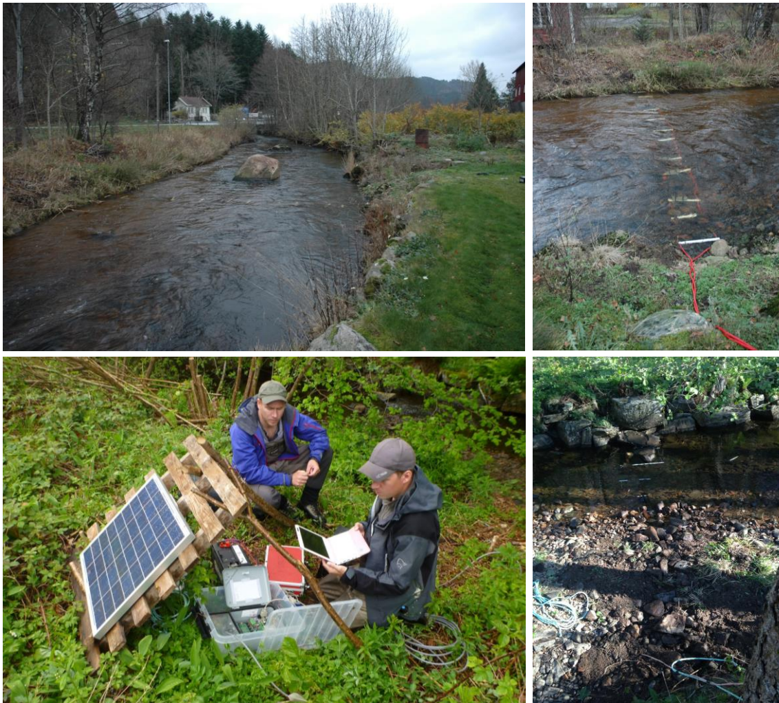
Figur 5. PIT-antenne for registrering av fiskevandring mellom bekk og fjord i Sjølingstadbekken (øverst) og Ånavassdraget (nederst). Antennen er tilkoblet en lagringsenhet som driftes på 12v og solcelle i Ånavassdraget (nede venstre) (Foto: T. Haraldstad og L. Bendixby).
