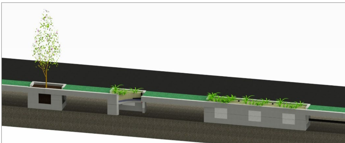
Figur 9. Eksempelskisse på fleksible regnbed bygd opp i prefabrikerte betongenheter med mulighet for prøvetaking som del av demonstrasjons- og testanlegget (Skisse: Sogge Johnsen).
