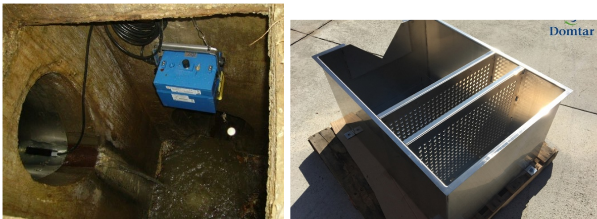
Figur 17 Areal/hastighet-flowmeter (til venstre) og v-overløp (til høyre) (kilde: ISCO 2150, bilde fra watec.it, https://www.openchannelflow.com/weirs/weir-boxes ).
