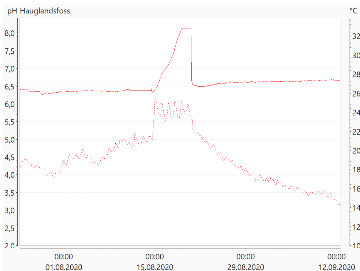
Figur 4. Stopp i gjennomstrømming av målekyveta for pH oppstrøms Hauglandsfoss doseringsanlegg, stiplet kurve er temperatur.
