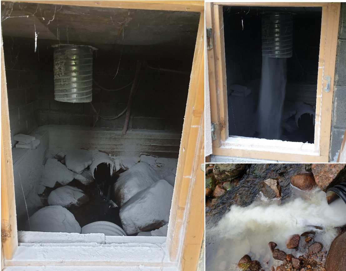
Figur 1. Tørt kalksteinsmel doseres ut i et rom under anlegget med gjennomstrømmende bekkevann. Det doseres med en fast doseringshastighet.
