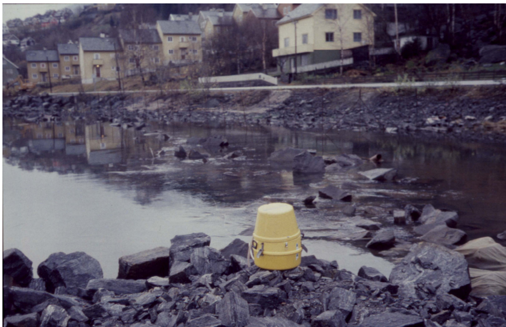
Figur 5. Bildet viser bruk av automatisk vannprøvetaker i Eitrheimsvågen i 1984. Målet var å registrere utvasking av tungmetaller fra deponiene i strandkanten (Foto: Jens Skei, NIVA).
