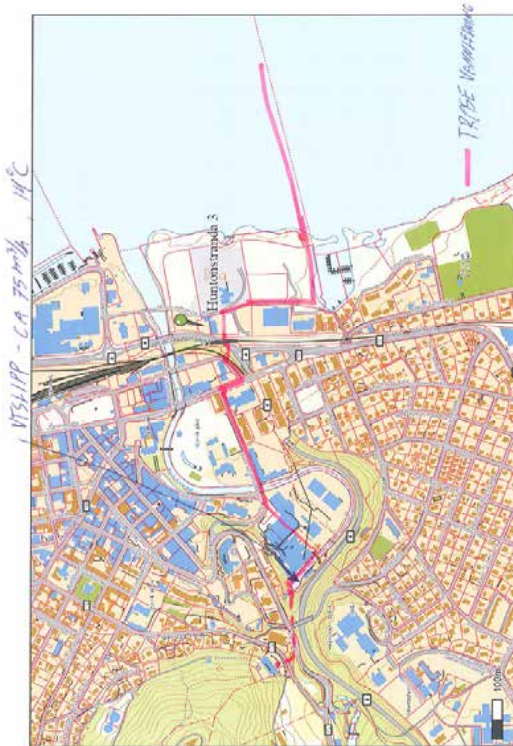
Figur 9. Kart som viser skissert trasé for den planlagte vannledningen fra Mjøsa, til Evry og til utslipp i Hunnselva ved Hunton. Gjengitt fra Eidsiva bioenergi.
