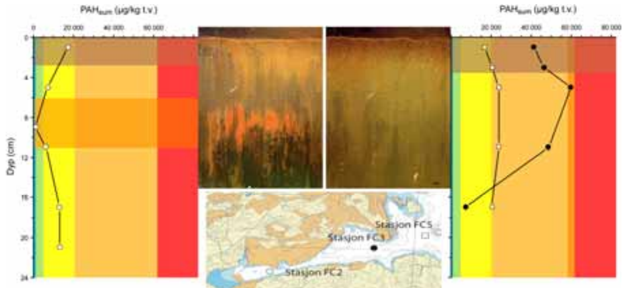
Figur 10. Fordeling av PAH i forskjellige snitt i sedimentet sammenlignet med et SPI-bilde fra de 3 stasjonene FC2, FC3 og FC5 (FC2 til venstre og FC3/FC5 til høyre). Vertikalt fargede band i diagrammet = SFTs tilstandsklasser (Molvær m. fl. 1997). Horisontale fargeband i diagrammet indikerer dypet av den aktive biologiske sonen (RPD) og det oransje sjiktet (FC2).
