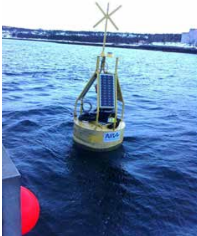
Figur 2. Marin målerigg med bøye i overflaten som markerer posisjon til rigg. Solcellepanel benyttes for å sikre kontinuerlig målinger uten bytte av batterier. Figuren er gjengitt fra Ledang og Berge (2014).
