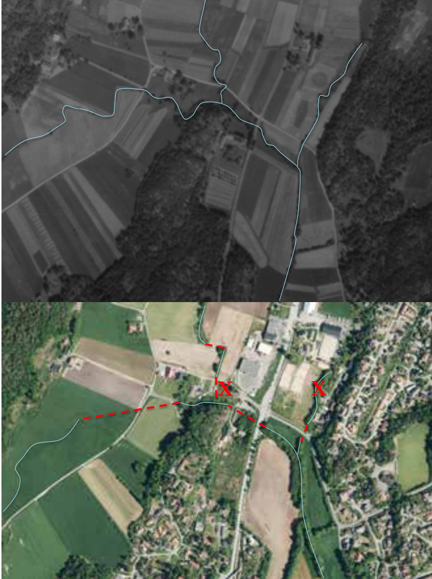
Figur 5. Det har vært betydelig bekkelukking i Nedenesbekken (rød stiplede linje) fra 1946 (øverst) til 2012 (Nederst) flere sidegreiner er også utilgjengelige pga feil kulvertdesign (røde kryss) (Statens kartverk).
