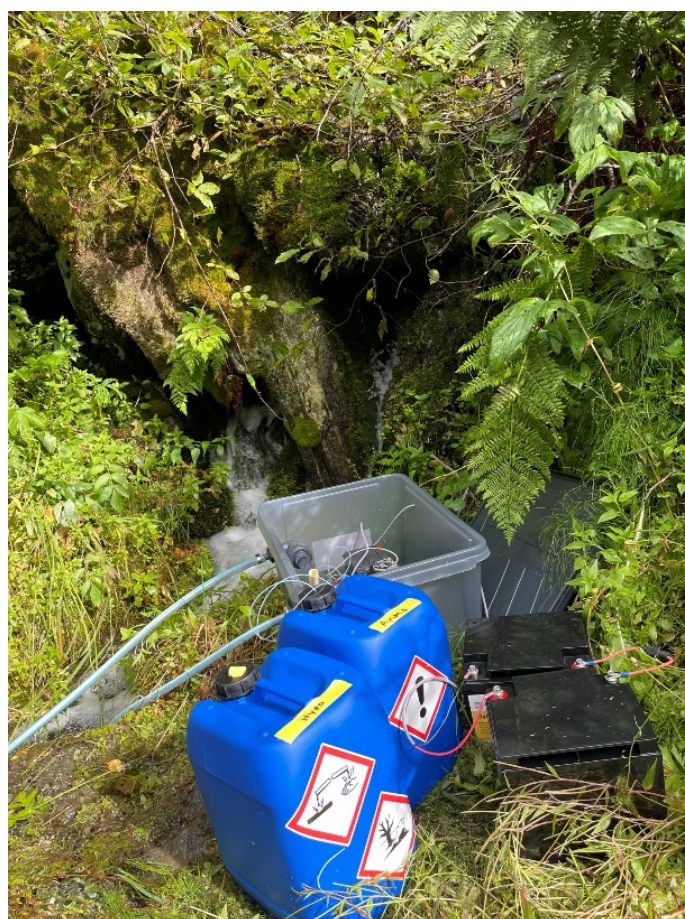
Figur 8. Doseringsoppsett for sidebekker med kjemikalier (blå kanner), strømtilførsel via batteri, samt pumpekasse. Foto: Marit Måsøy Amundsen/Veterinærinstituttet.
