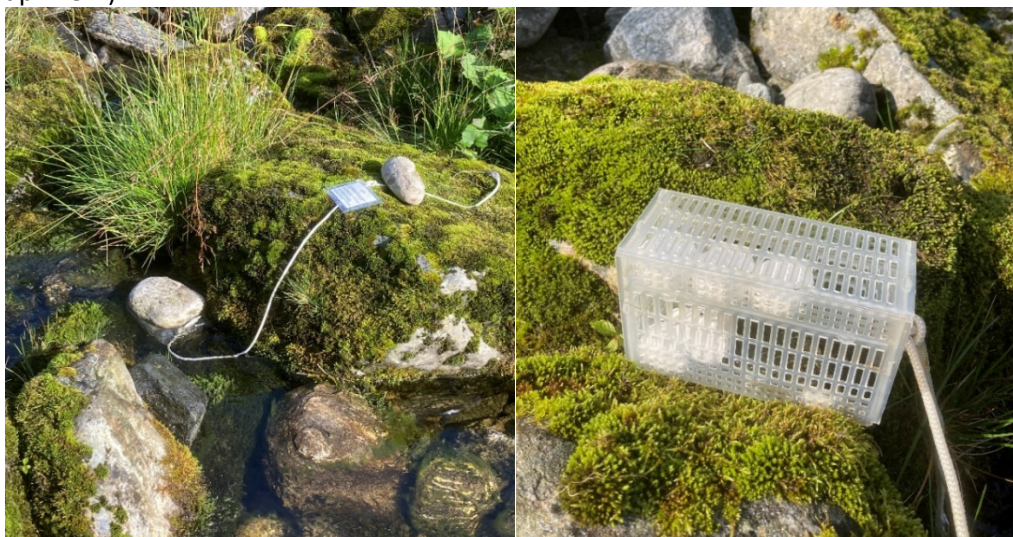
Figur 9. Vibertboks med klortabletter (høyre) og utplassering i bekk (venstre). Foto: Øyvind Garmo/NIVA.
