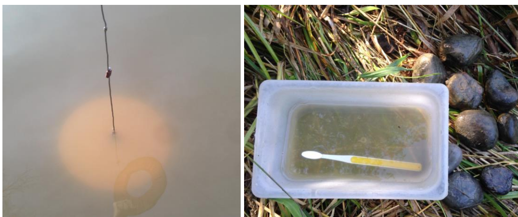
Figur 15. Stasjon Vestelva1. Siktedypet avtar fort i vassdrag med høyt innhold av suspendert materiale (t.v.). På de strømutsatte partiene fantes det tilstrekkelig med substrat til å få tatt prøver (t.h.).
