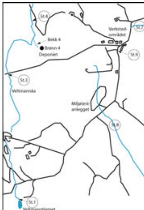
Figur 1. Bradalsmyra testsenter med veinett, bekker og prøvetakningspunktene i Veltmannåa (St.1, 3 og 4), fra verkstedsområdet (st. 7), miljøtestsenteret (st. 8), raketstandplass(st.9) og i en grunnvannsbrønn (brønn 4) nedstrøms deponiet. I 2011 var denne brønnen fylt av sedimenter og nytt prøvepunkt (bekk 4) ble etablert i et grunnvannsig som kommer ut i dagen 15 m nedenfor brønn 4.
