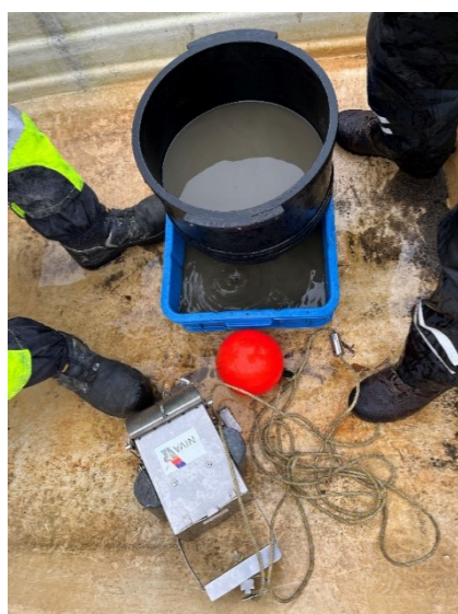
Figur 3. Utstyr benyttet til prøvetaking av bunndyr. Nederst i bildet ses Ekman-grabben som ble benyttet for innhenting av sediment. Øverst i bildet ses den runde silen med maskevidde 0,5 mm som ble benyttet for å fjerne finsediment fra prøvene. Foto: Jonas Persson.
