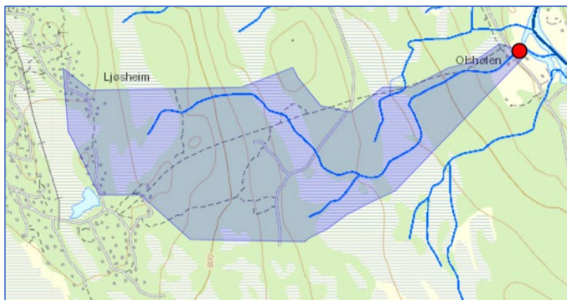
Figur 8. Delnedbørsfelt til stasjon 5, Olshølbekken med noe infrastruktur/hyttebebyggelse (mulig avrenning fra Hygga).
