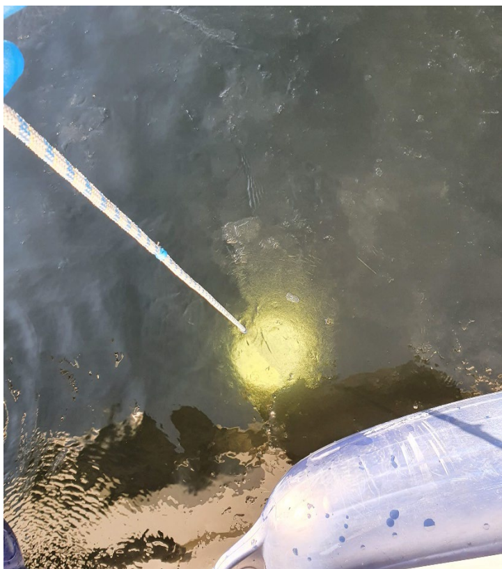
Figur 10. Siktdypet måles ved at en hvit Secchi-skive senkes ned i vannsøylen til man ikke lenger kan se den. Siktdypet er det dypet der du akkurat får øye på skiven når den trekkes opp igjen.
