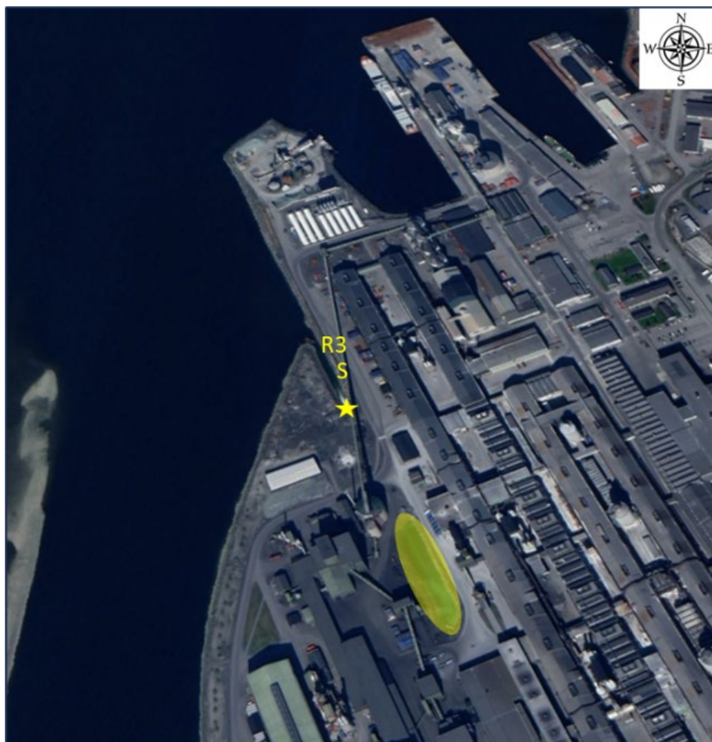
Figur 8. Skråblikk i nordlig retning over Alcoa Mosjøen. Klaringsbassenget er markert med gult område. Hovedutløp (gul stjerne) og separate utslippspunkter hhv. for støperi (S) og R3 er markert. Kart fra Google Earth.
