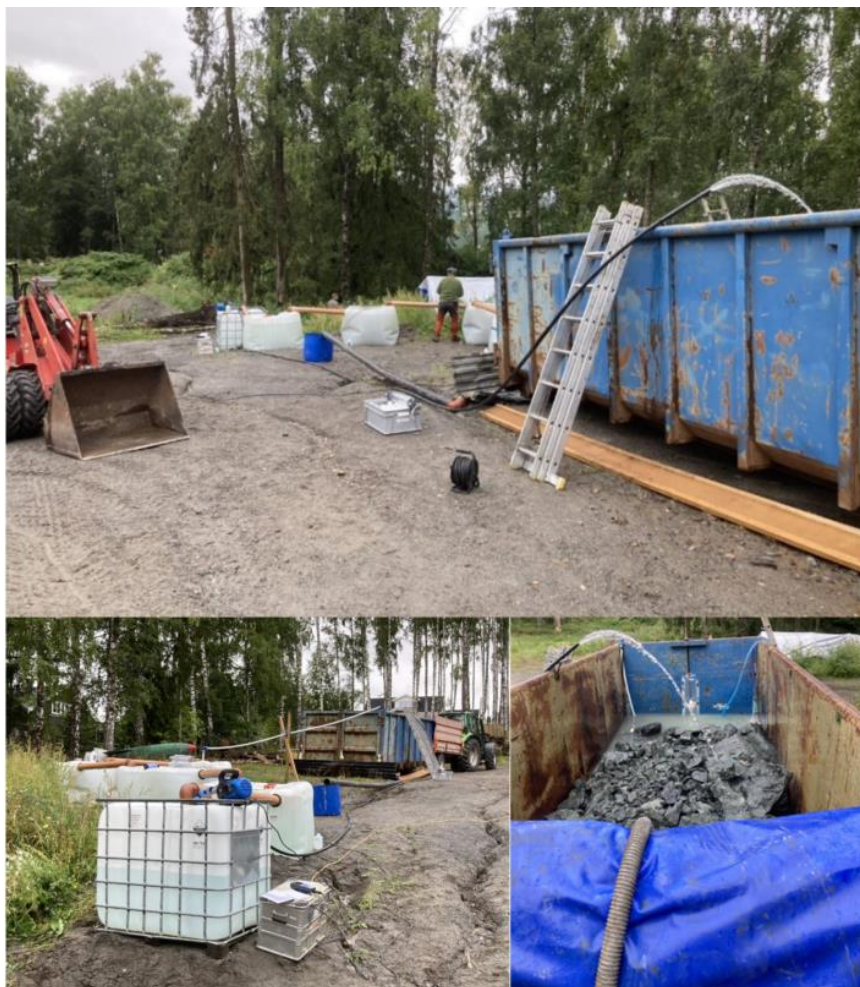
Figur 7. Forsøksoppsett; kontainer med 8 m 3 samfengt sprengsein og fem 1000 liters IBC tanker tilført vannmasser som sirkulerer gjennom mekanisk pumpe og fall. Foto Øyvind Garmo.
