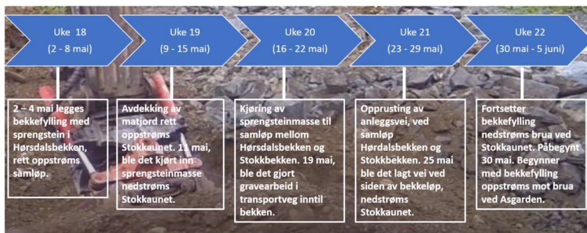
Figur 5. Anleggsarbeid i Stokkbekken og Hørdsalsbekken i mai 2022
