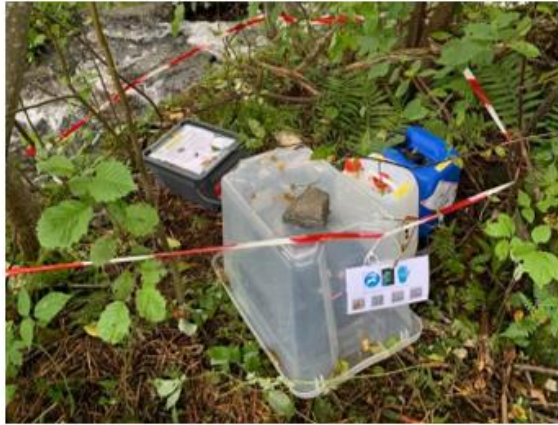
Figur 7. Venstre: Standard blandestasjon fra behandlingen i 2023. Hypokloritt og ammoniumklorid ble pumpet, ved hjelp av en tokenals peristaltisk slangepumpe, ned til en blandestav nedsenket i bekken, hvor selve innblandingen foregikk. (Foto: Stine Marie Iversen/NIVA). Høyre: Øverst i sidebekken Skorga ble det behandlet fra to separate punkter, begge ved hjelp av peristaltiske pumper med større kapasitet enn standardpumpene (Foto: Petter Nergaard/NIVA).
