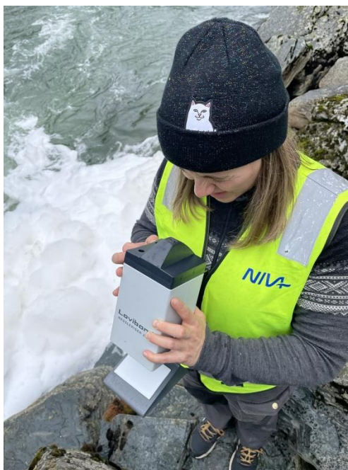
Figur 13. Avlesning av estimert klorkonsentrasjon ved hjelp av komparator. Foto: Marit Måsøy Amundsen/Veterinærinstituttet
