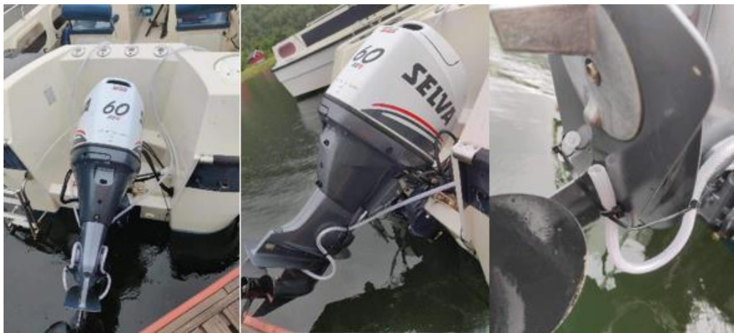
Figur 10. Bilde av doseringsslanger montert på motoren. Foto. Solveig Storfjell/NIVA
