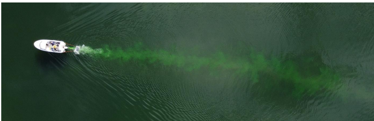
Figur 9. Test med fluorescein i båthavna for å vurdere horisontal innblanding av doseringen.
