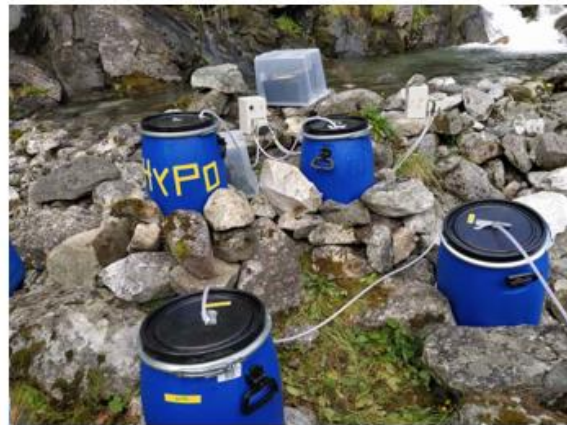
Figur 7. Venstre: Standard blandestasjon fra behandlingen i 2023. Hypokloritt og ammoniumklorid ble pumpet, ved hjelp av en tokenals peristaltisk slangepumpe, ned til en blandestav nedsenket i bekken, hvor selve innblandingen foregikk. (Foto: Stine Marie Iversen/NIVA). Høyre: Øverst i sidebekken Skorga ble det behandlet fra to separate punkter, begge ved hjelp av peristaltiske pumper med større kapasitet enn standardpumpene (Foto: Petter Nergaard/NIVA).
