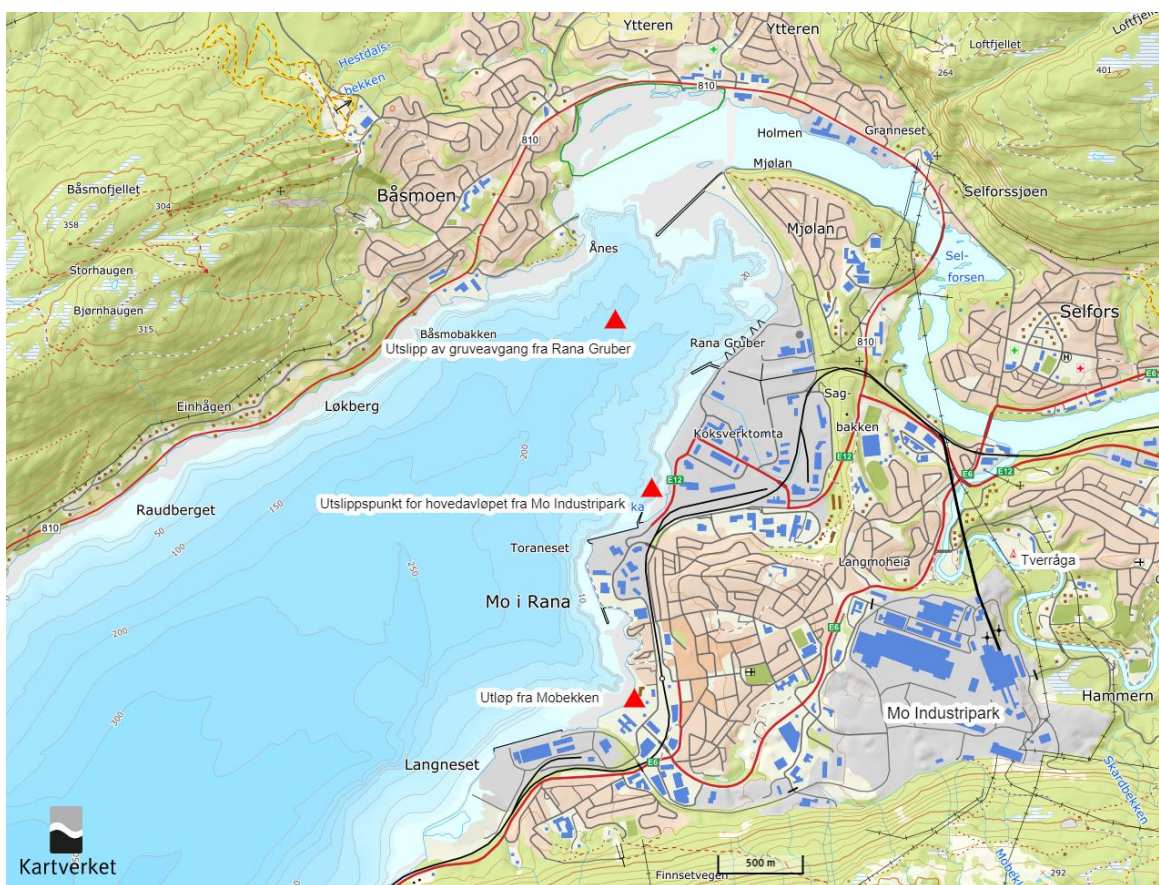
Figur 4. Utslippspunkter til den indre delen av Ranfjorden fra de bedriftene som er med i overvåkingen (røde trekantsymboler). Gruveavgang fra Rana Gruber går ut på ca. 120 meters dyp. Avrenning fra deponier i Mo Industripark samt overvann drenerer til Mobekken (utløp markert med pil på bilde B). Utslipp fra Miljøteknikk Terrateam går også ut via Mobekken. Prosessvann går ut med hovedavløpet med utslipp på 30 meters dyp (markert med pil på bilde A).
