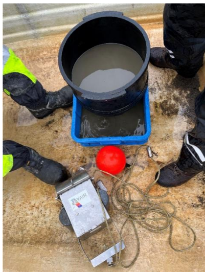
Figur 5. Utstyr benyttet til prøvetaking av bunndyr. Nederst i bildet ses Ekman-grabben som ble benyttet for innhenting av sediment. Øverst i bildet ses den runde silen med maskevidde 0,5 mm som ble benyttet for å fjerne finsediment fra prøvene. Foto: Jonas Persson.
