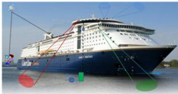
Figur 2. MS Color Fantasy illustrert med dekkens sensorer for lys (rød), havfarge (grønn), overflatetemperatur (blå og grønn) kommunikasjon til land og FerryBox systemets omtrentlige plassering i fartøyet.
